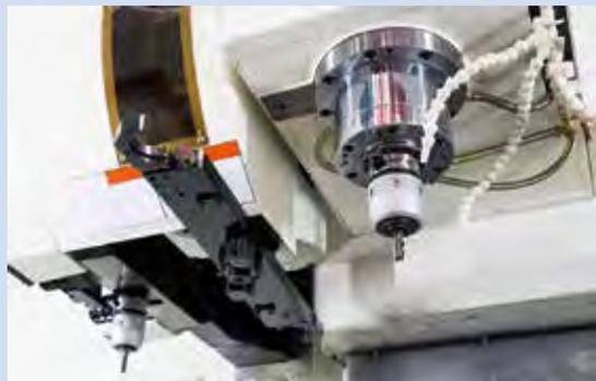
金属加工においてはスピンドル(主軸)の不具合が加工製品に影響を与えます。
