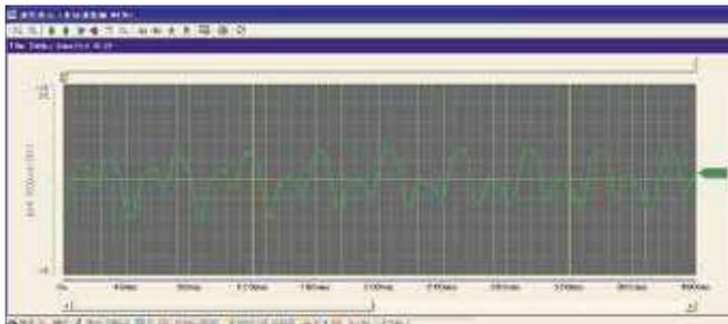
左と同じ2つの回転機が回っている振動の加速度波形を記録すると以下の様な波形になります。より、高周波数の波形が記録されます。
