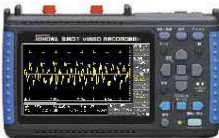
より高周波数の振動波形を加速度モードで表示した例
