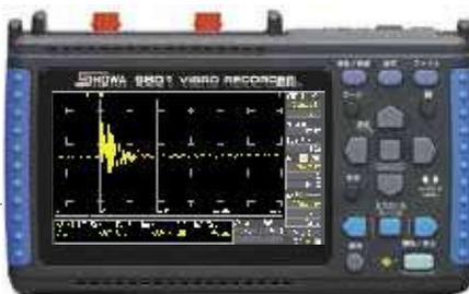
落下衝撃を加速度波形で表示した例
