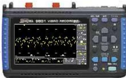
送風機の振動波形を変位モードで表示した例
