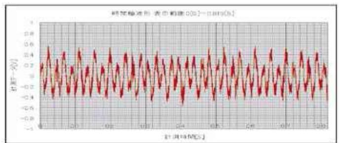
振動加速度波形を、FFT解析したグラフです。変位の時よりも高周波数成分が出ています。
