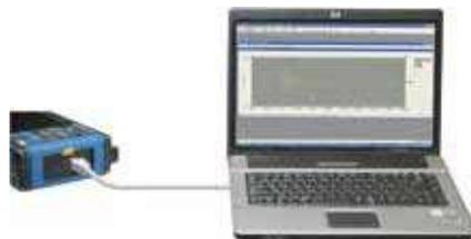
付属のUSBケーブルを使って、パソコンへCFカードのデータを転送することが出来ます。転送したデータは、パソコン上のソフトで加工ができます。(上のパソコン画面は、転送しファイルを付属ソフトで表示したもの)
