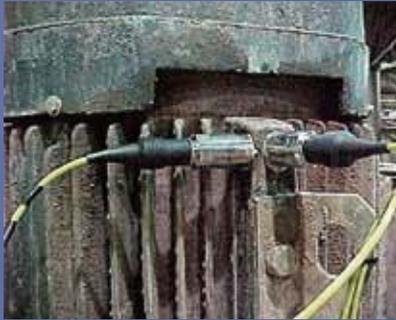
ポンプの回転軸に垂直になるようXY2方向にセンサを水平に取り付けています。
